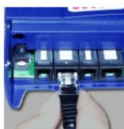
**6** Wenn Sie TeleScout QUADRO von einem PC aus konfigurieren oder die umfangreichen Auswertungsmöglichkeiten mit einem PC nutzen wollen, schließen Sie jetzt TeleScout QUADRO an Ihren PC an. Sonst fahren Sie bitte bei Nummer "7" fort.
