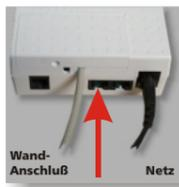
**5** Die einzelnen externen ISDN-Anschlüsse Ihrer Telefonanlage verbinden Sie mit den Kabeln Ihrer Anlage mit TeleScout QUADRO. Die Anschlüsse für Ihre Anlage sind die breiteren Buchsen des TeleScout QUADRO. Von links beginnend gehören jeweils eine schmale und eine breite Buchse zusammen (schmal = Eingang, breit = Ausgang).
