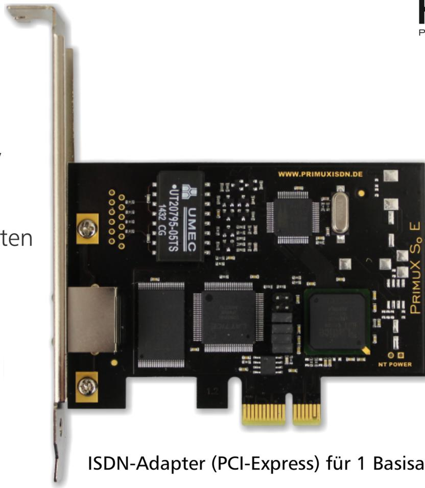
**ISDN-Adapter (PCI-Express) für 1 Basisanschluss (1 x S<sub>0</sub>)**
